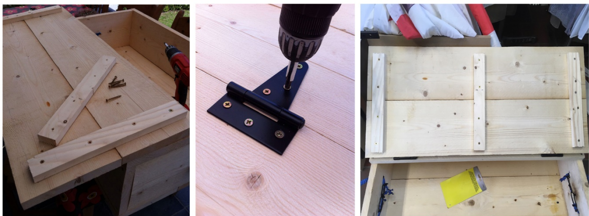
FIGUUR 19: BEVESTIGEN VAN HET DEKSEL
